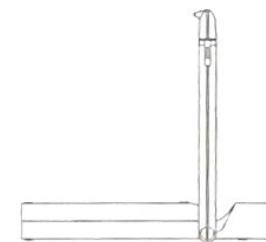
2. Освободите фиксирующее устройство поручня, поднимите поручень до вертикального угла и затяните фиксирующее устройство поручня.
