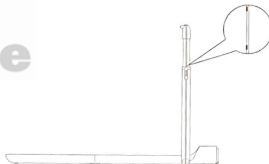
4. Отрегулируйте устройство для быстрой установки поручня на подходящую высоту, а затем зафиксируйте устройство. Желтые отметки на боковых сторонах поручня указывают рекомендуемые максимальную и минимальную высоты.
