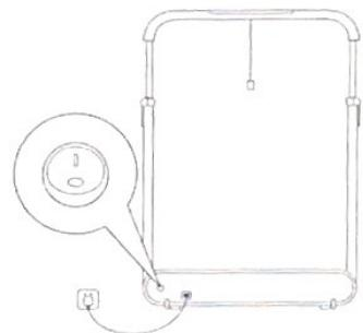
5. Установите замок безопасности, подключите к источнику питания и включите прибор.
